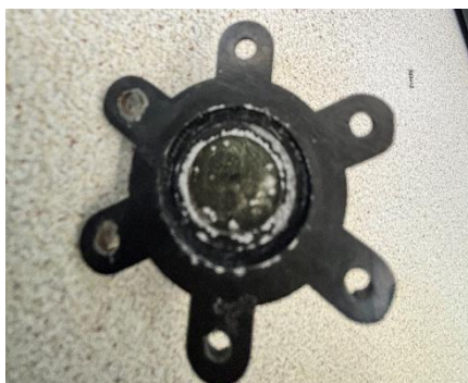
Figure 29 : Dépôt de sels sur la membrane
